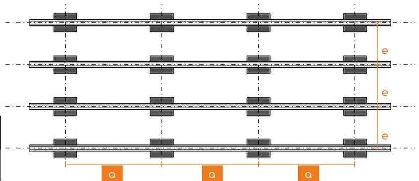
Die Nutzlast umschreibt die Last, die je qm Fläche zusätzlich zum Eigengewicht (bestehend aus Belag und Unterkonstruktion/Unterbau) aufgenommen werden kann bis die maximal angenommene Durchbiegung der Aluminium-Unterkonstruktion von 4 mm erreicht ist. Ggf. können für einen Gebäudebereich höhere Nutzlasten gefordert sein. Diese sind der Gebäudestatik und/oder der Baugenehmigung zu entnehmen. Flächenlast des Belags bis Oberkante Profil (inkl. Unterkonstruktion/Unterbau des Belags): 0,58kN/qm
