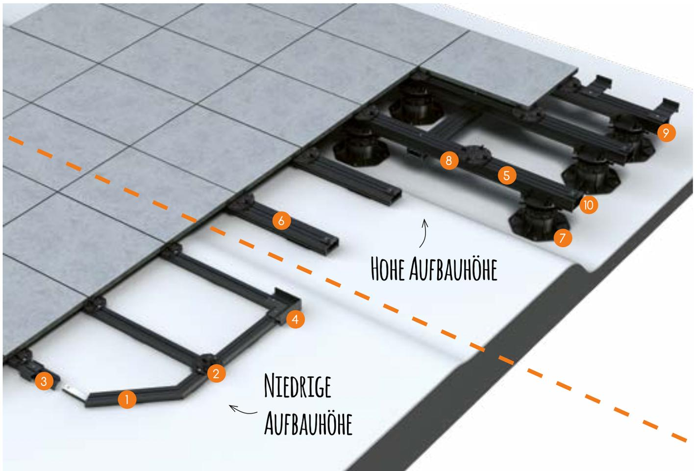
Verlegung von Terrassenplatten bei niedriger Aufbauhöhe:
