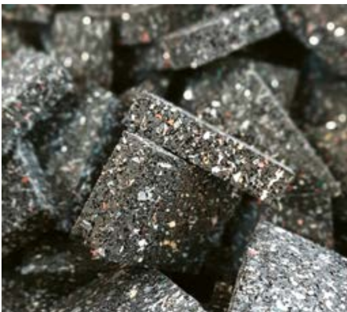
Isopads aus 95 % Altreifengranulat
