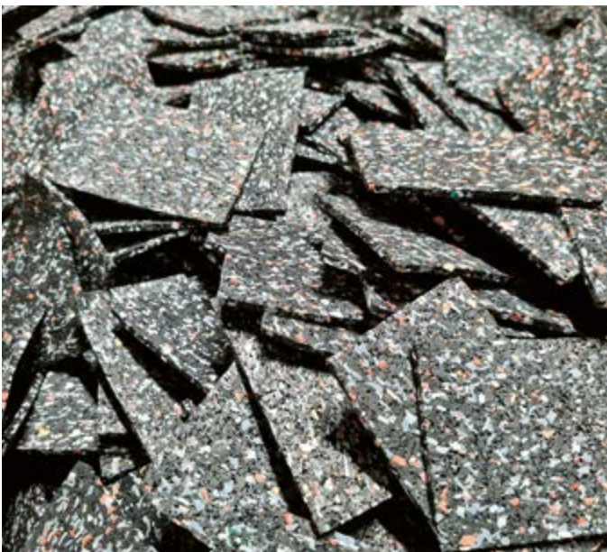
Isopads aus 95 % Altreifengranulat
