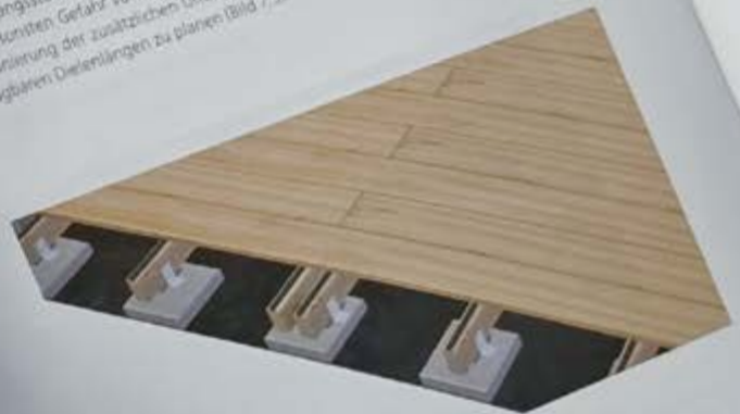
Bild 7.3 Ausführung von Längsstößen zwischen zwei Auflagern
